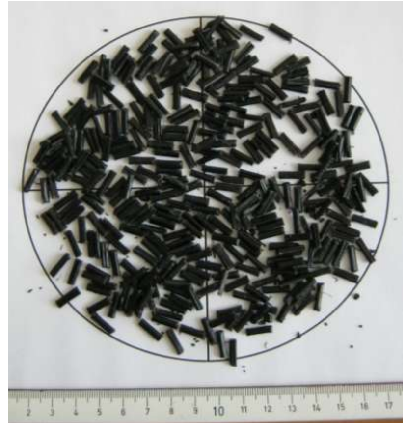
Cestran® tecnologia de pultrusão com total impregnação das fibras*
