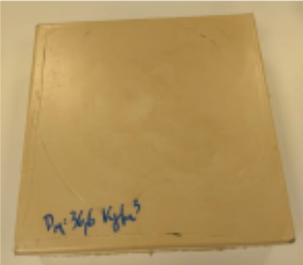
Figura 01: Amostra RECICLAGEM D= 36,6 kg/m³
