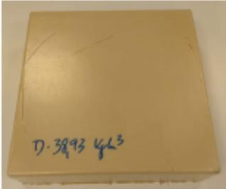
Figura 02: Amostra RECICLAGEM D= 38,93 kg/m³
