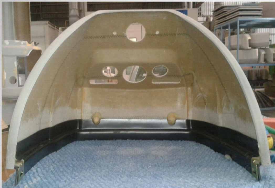
Painel de Fibra de Vidro Complemento de ABS e Reforços Metálicos.
