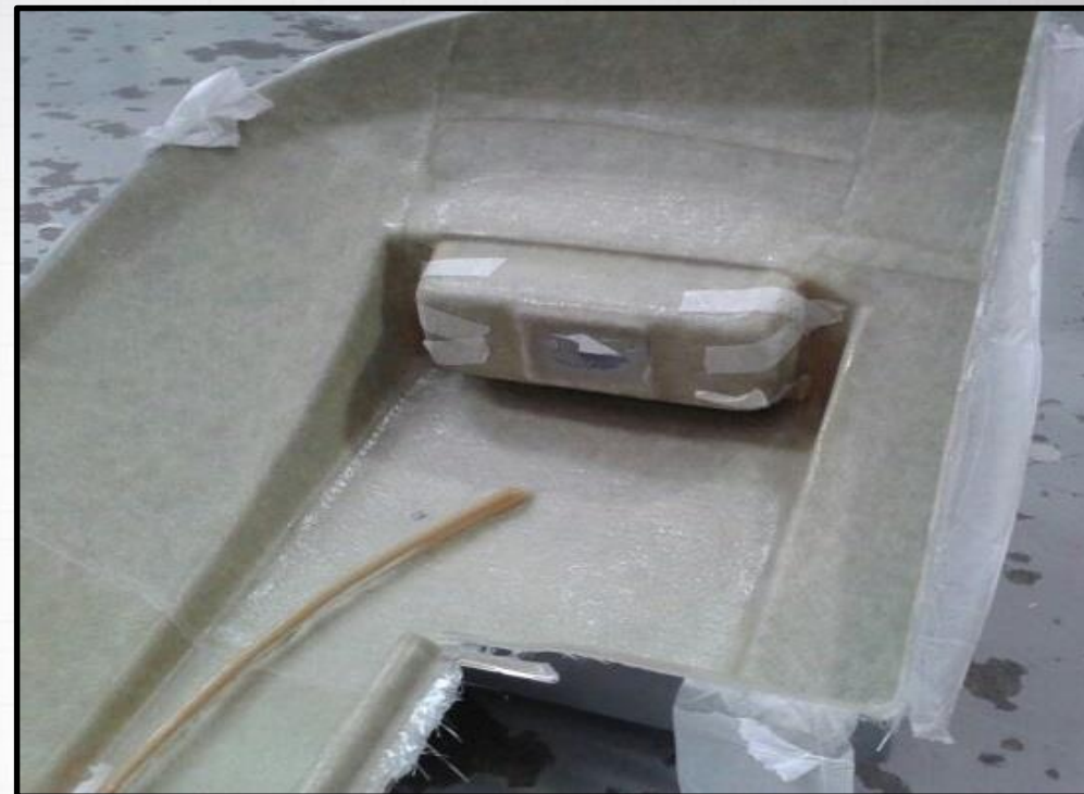
Complemento Para Lama Trator BX 200 CV com a embolsagem unificada em Fiberglass com teor de vidro \approx 30\% ;
