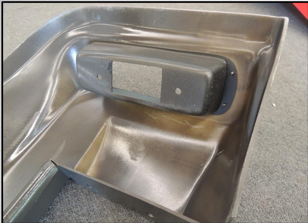
Complemento Para Lama Trator BX 200CV com a embolsagem em ABS preto 5mm fixada com rebite;
