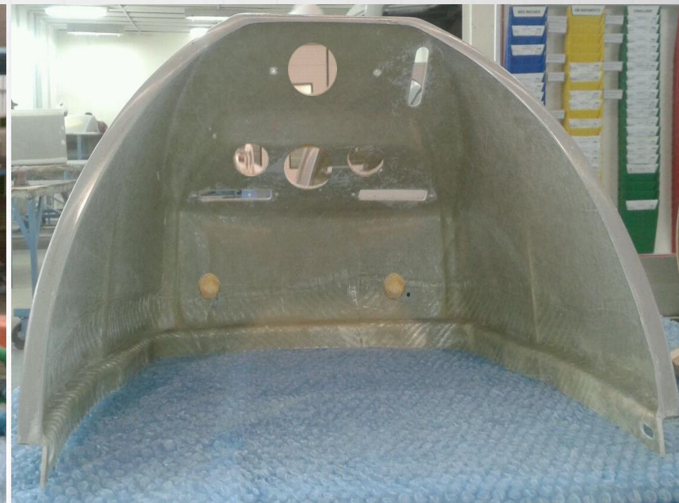
Painel totalmente em Fibra de Vidro, sem o uso de Reforços Metálicos.
