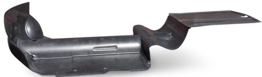
Túnel da central de composto Honeycomb
