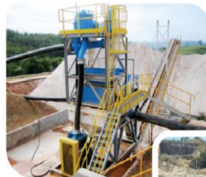
Clarificadores / Espessadores São indicados no tratamento de efluentes e águas residuais geradas no processo de lavagem de brita, areia e minerais.
