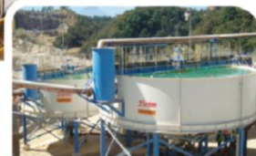
Clarificadores / Espessadores São indicados no tratamento de efluentes e águas residuais geradas no processo de lavagem de brita, areia e minerais.
